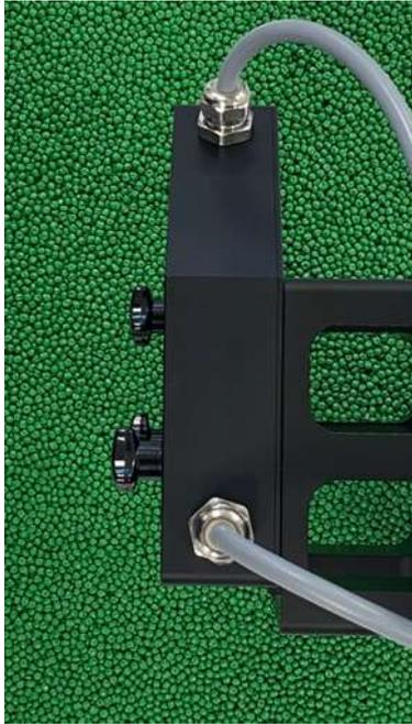
valeurs colorimétriques d'une précision typique de  $dE = 0,3$ . Par ailleurs, Il est même possible de mesurer le produit recyclé à des températures élevées. On utilise alors un frontal optomécanique, c'est-à-dire un capteur dont la tête ne contient aucun composant électronique.
